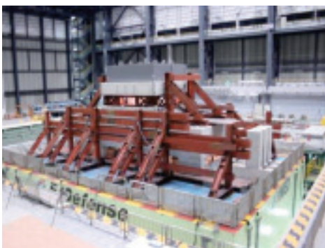
水平免震システムの振動台試験
